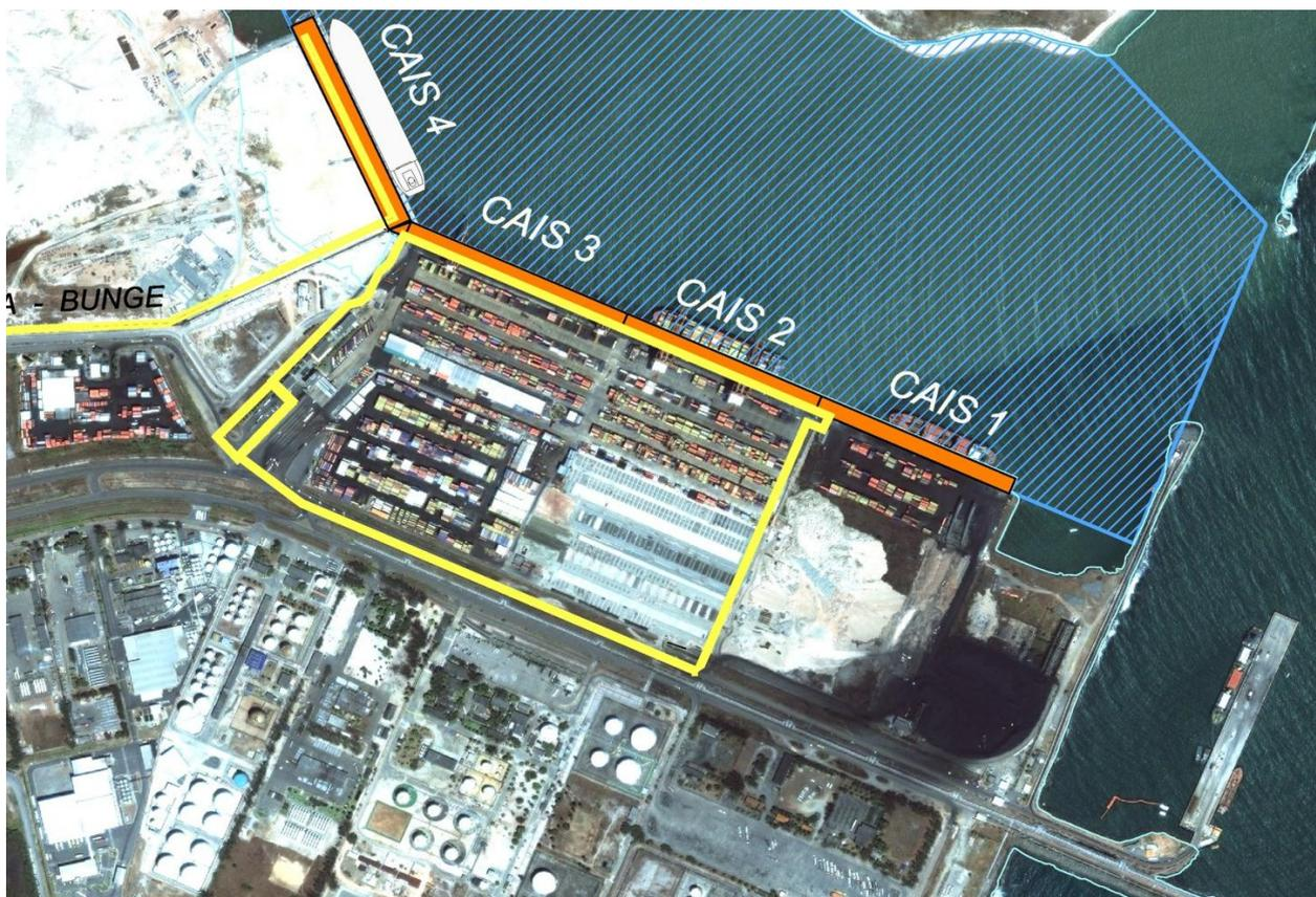
Segundo informações do próprio TECON, a configuração atual do terminal, incluindo os equipamentos de pátio existentes, permite a movimentação de cerca de 400.000 contêineres por ano.
